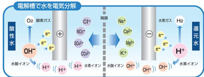
⊕極では、水分子から電子が放出され酸素が発生し、水素イオン濃度が高くなって酸性となり、⊖極では、水分子から水素と水酸イオンが発生し、アルカリ性(還元)になります。
